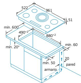
\* En instalación sobre hornos de 60 cm u hornos compactos de 42 cm: mínimo 30 mm. Con resto de hornos compactos: mínimo 60 mm.
