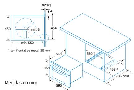
En instalaciones bajo placa de cocción, prever un espesor de encimera de 60 mm.
