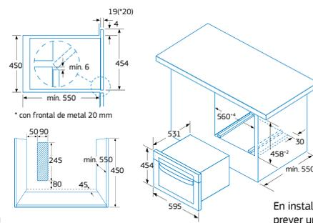
En instalaciones bajo placa de cocción, prever un espesor de encimera de 60 mm.
