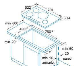
\* En instalación sobre hornos de 60 cm u hornos compactos de 42 cm: mínimo 30 mm. Con resto de hornos compactos: mínimo 60 mm.
