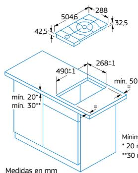
Mínimo espesor de la encimera en instalación sobre horno:
