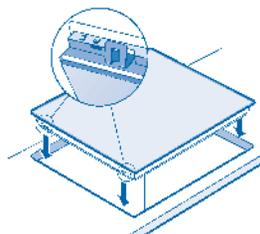
El sistema de anclaje y la junta de estanqueidad vienen fijados a la placa desde fábrica.
