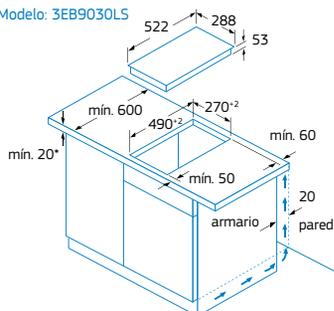
\* En instalación sobre hornos de 60 cm u hornos compactos de 42 cm: mínimo 30 mm. Con resto de hornos compactos: mínimo 60 mm.
