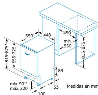
\* Altura variable mediante patas ajustables.
