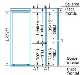
Las dimensiones de la puerta del mueble corresponden a una junta de puerta de 4 mm. Si se utiliza una junta de un ancho diferente (máx. 14 mm) las medidas deben adaptarse.
