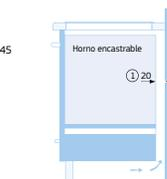
\* En instalación sobre hornos de 60 cm u hornos compactos de 42 cm: mínimo 30 mm. Con resto de hornos compactos: mínimo 60 mm.
