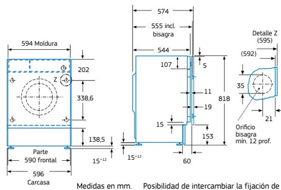
Medidas en mm. Posibilidad de intercambiar la fijación de la puerta del mueble.
