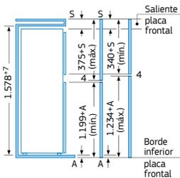
Las dimensiones de la puerta del mueble corresponden a una junta de puerta de 4 mm. Si se utiliza una junta de un ancho diferente (máx. 14 mm) deben adaptarse las medidas.
