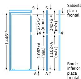
Las dimensiones de la puerta del mueble corresponden a una junta de puerta de 4 mm. Si se utiliza una junta de un ancho diferente (máx. 14 mm) deben adaptarse las medidas.
