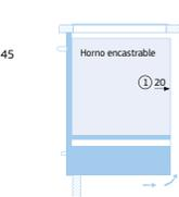
\* En instalación sobre hornos de 60 cm u hornos compactos de 42 cm: mínimo 30 mm. Con resto de hornos compactos: mínimo 60 mm.
