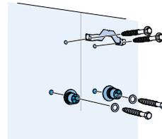
**B** Después de colgar el cuerpo de la campana, se ajusta manualmente la posición horizontal y vertical con el simple giro de los soportes.
