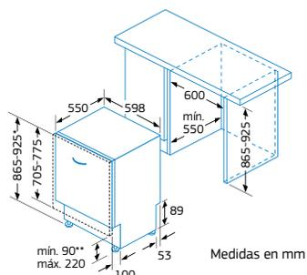
\* Altura variable mediante patas ajustables.
