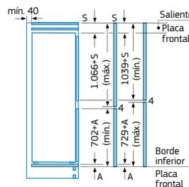
Las dimensiones de la puerta del mueble corresponden a una junta de puerta de 4 mm. Si se utiliza una junta de un ancho diferente (máx. 14 mm) las medidas deben adaptarse.
