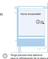
\* En instalación sobre hornos de 60 cm u hornos compactos de 42 cm: mínimo 30 mm. Con resto de hornos compactos: mínimo 60 mm.
