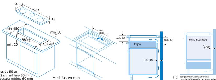
\* En instalación sobre hornos de 60 cm u hornos compactos de 42 cm: mínimo 30 mm. Con resto de hornos compactos: mínimo 60 mm.
