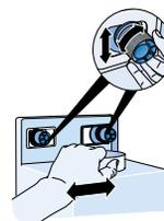
**C** Para fijar el tubo decorativo, es posible realizar un premontaje gracias a un "clip" de fijación, de manera que el atornillado es mucho más preciso y cómodo.
